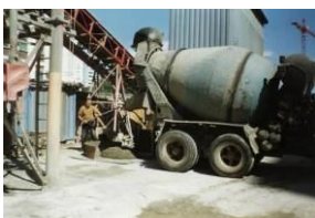
Рис. 4.2.1.9 – 4.2.1.10 Ручной способ производства БИМАФ на заводе товарного бетона
