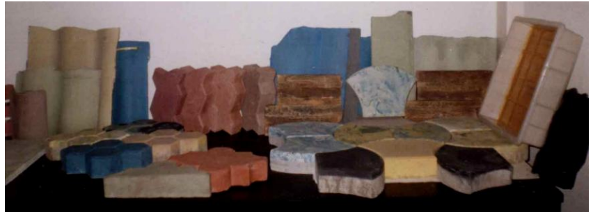
Рис. 4.2.2.1.2.2 Тротуарные плиты, из механоактивированных цветных и серых портландцементов нового поколения, отформованные литьевым способом (Коломна)
