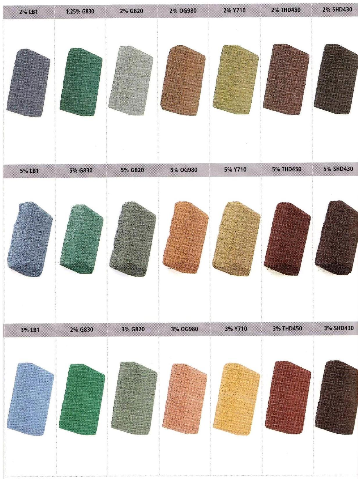
Рис. 4.1.4.2 Образцы бетона из серого и белого (нижний ряд) портландцементов, окрашенные колеровочными пастами PRECOLOR
