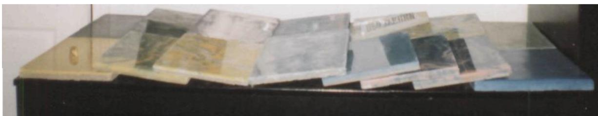
Рис. 4.1.1.5.5 Декоративные плиты «под мрамор», изготовленные из ПЦЦЛ литьём
