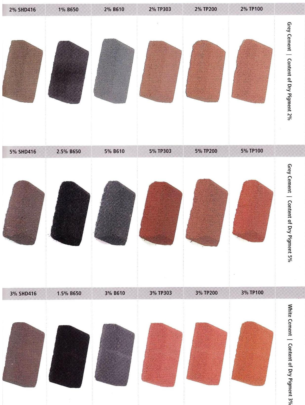
Рис. 4.1.4.1 Образцы бетона из серого и белого (нижний ряд) портландцементов, окрашенные колеровочными пастами PRECOLOR
