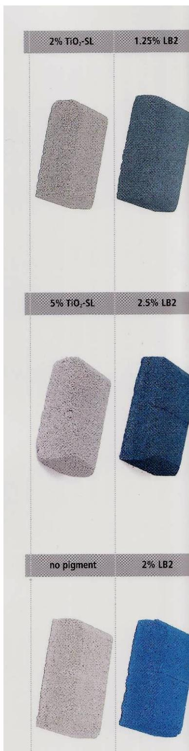
Рис. 4.1.4.3. Образцы бетона из серого и белого (нижний ряд) портландцементов, окрашенные колеровочными пастами PRECOLOR
